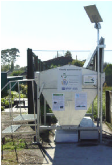
Tat-G Organic Digester at MIT
